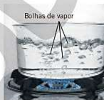
A formação de bolhas de vapor indica ebulição.
