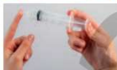
Teste simples, provando que o ar é comprimível.
