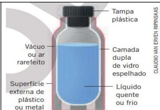
A garrafa térmica reduz a propagação de calor, possibilitando que o líquido se mantenha em sua temperatura inicial por mais tempo. Elementos fora de escala de tamanho e de proporção. Cores fantasia.
