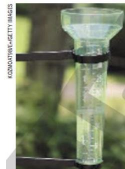
O pluviômetro deve ser instalado em local aberto para que possa coletar a água da chuva.
